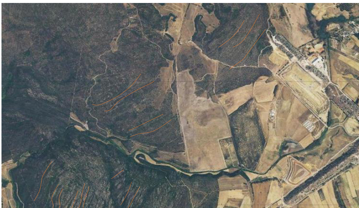
Figura 5-3 Foto aerea dell'area e superfici di discontinuità dell'ammasso roccioso
